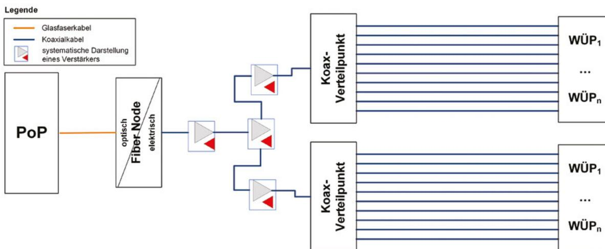
Abbildung 3: Prinzip der HFC-Netzinfrastruktur
