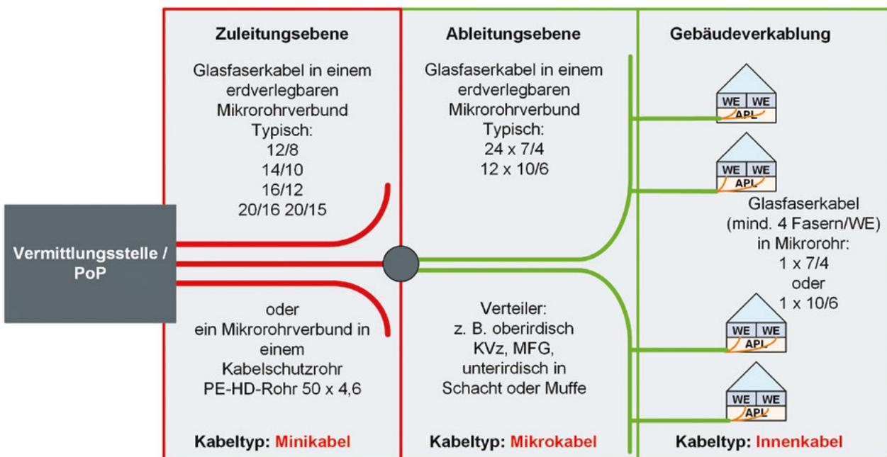
Abbildung 13: Darstellung der Verteilebenen vom PoP bis zur WE mit Materialspezifikationen
