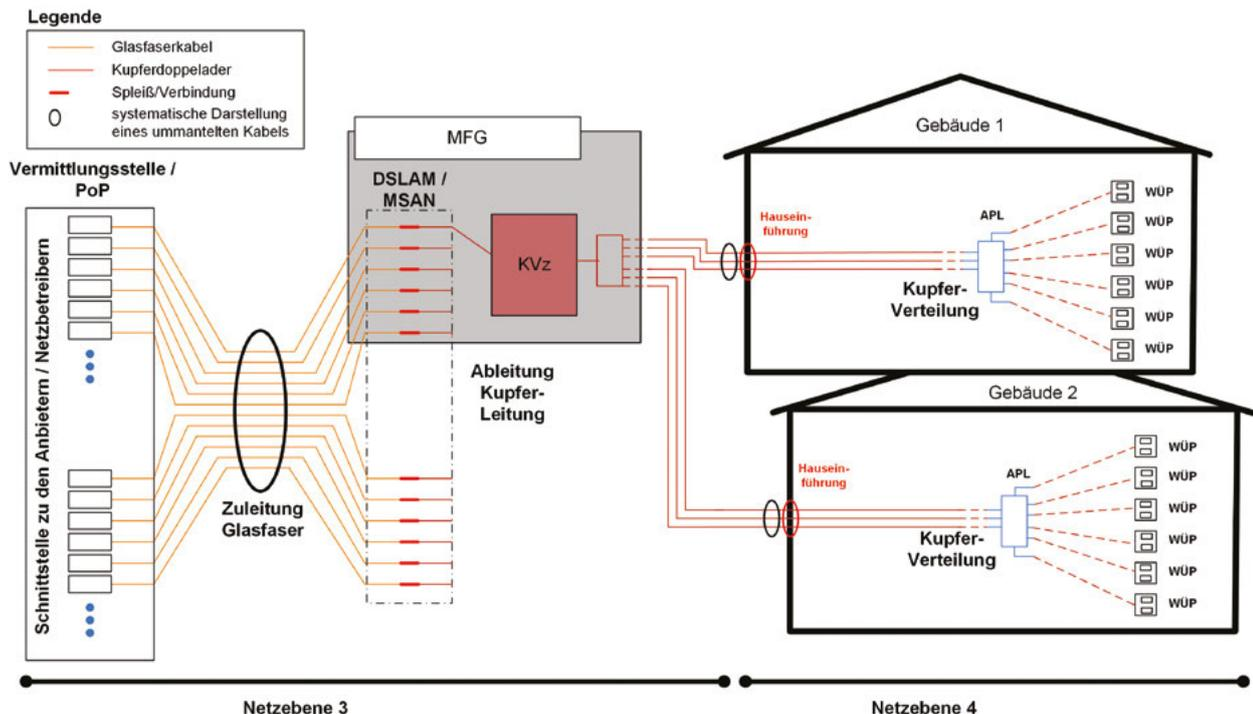
Abbildung 10: Referenzmodell Kupferdoppelader-Netzinfrastruktur (xDSL)
