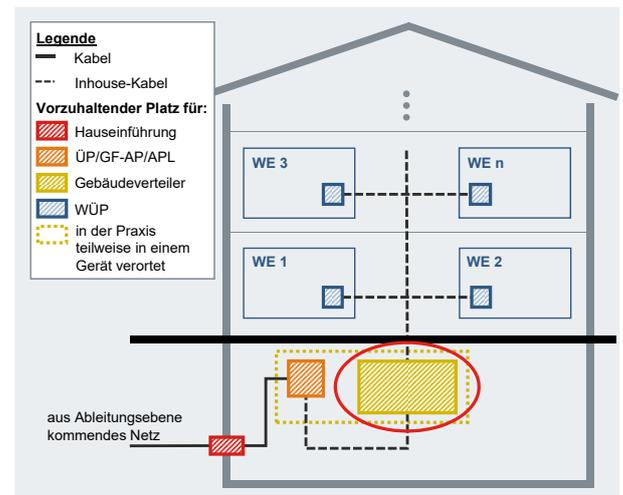
Abbildung 38: Schematische Darstellung des Platzbedarfs der Elemente von Netzinfrastrukturen im Inhouse-Bereich in einem Mehrfamilienhaus; hier Fokus auf dem Gebäudeverteiler
