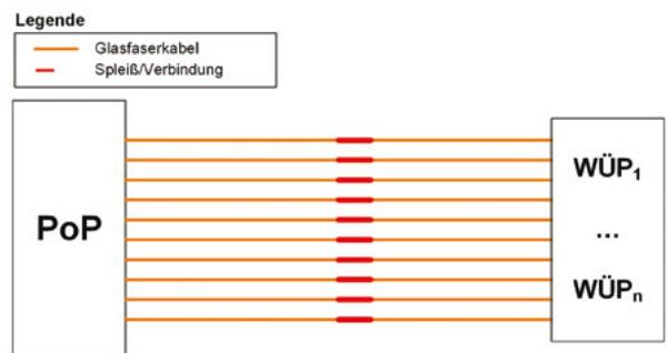
Abbildung 5: Prinzip der PtP-Netzinfrastruktur
