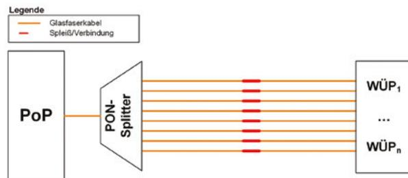
Abbildung 7: Prinzip der PON-Netzinfrastruktur
