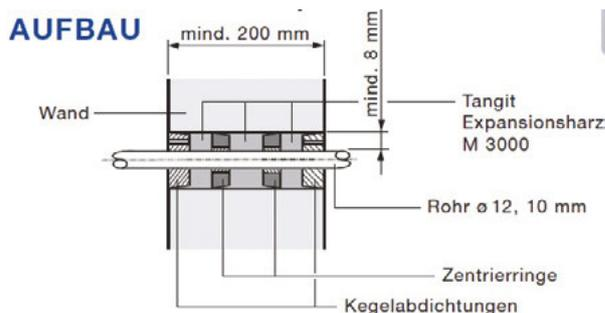
Abbildung 24: Beispielhafte Abdichtung einer Einspartenhaus-einführung
