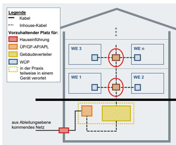
Abbildung 49: Schematische Darstellung des Platzbedarfs der Elemente von Netzinfrastrukturen im Inhouse-Bereich in einem Mehrfamilienhaus; hier Fokus auf dem Etagenverteiler
