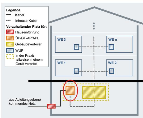
Abbildung 29: Schematische Darstellung des Platzbedarfs der Elemente von Netzinfrastrukturen im Inhouse-Bereich in einem Mehrfamilienhaus; hier Fokus auf dem Übergabepunkt
