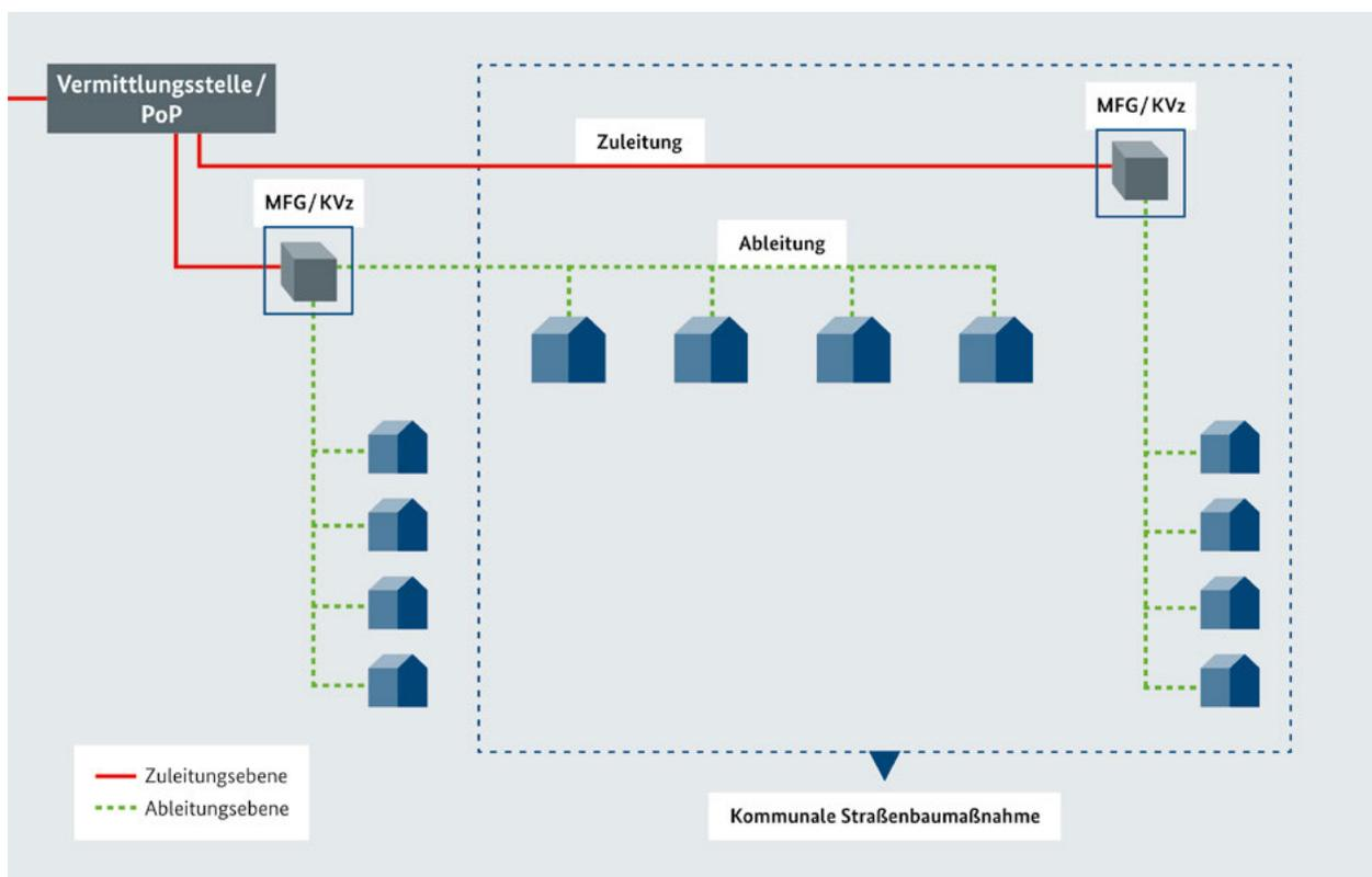
Abbildung 11: Schematische Darstellung der Netzinfrastruktur mit Netzebenen
