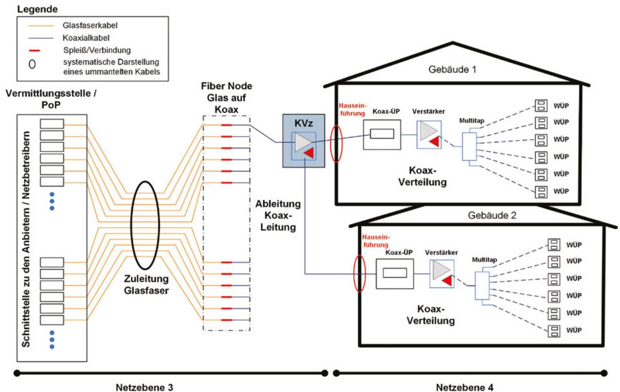
Abbildung 2: Referenzmodell HFC-Netzinfrastruktur
