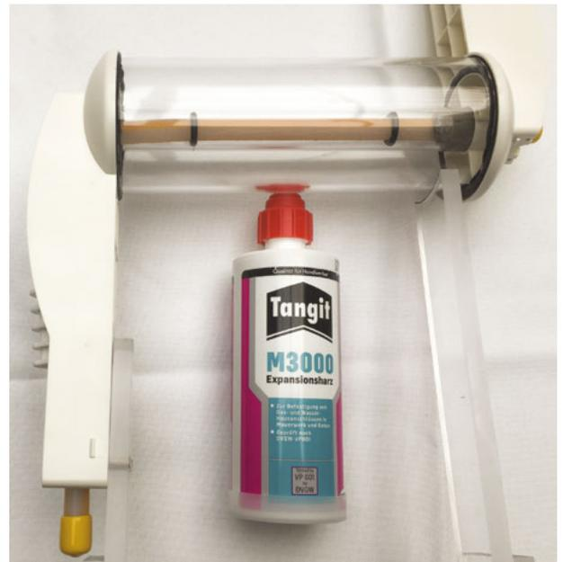
Abbildung 25: Beispielhafte Abdichtung einer Einspartenhaus-einführung mit Expansionsharz
