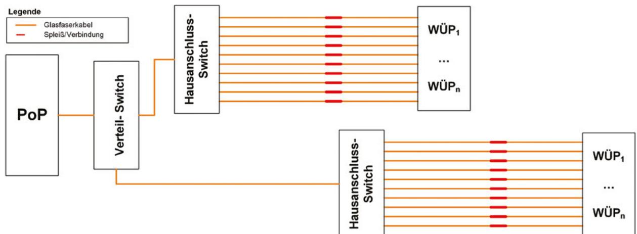
Abbildung 9: Prinzip der PtMP-Netzinfrastruktur mit mehreren Hausanschlussswitchen
